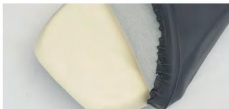
・タッカーのピンを外しシートカバーを外します
