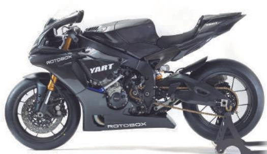
ROTOBOXホイールブーストは、中空スポークの超軽量カーボンホイールです。業界初の3成分複合材と、独自のワンピース中空カーボンキャスト構造により実現しました。空力を考慮した5本の中空スポークが特徴で、スポーツバイクからクラシックバイクまで幅広いジャンルに対応します。※車種によりハブ形状やディスク取り付け形状で重量が異なります。
