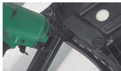
・タッカーピンを外し純正シートカバーを外します※車種によっては純正カバーの上からルイモトカバーを貼ることも可能です
